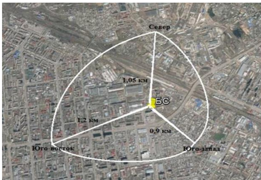
4.12 Сурет - Окомура және Хата моделінің параметрлері арқылы есептелген LTE үшін қамту аймағы
